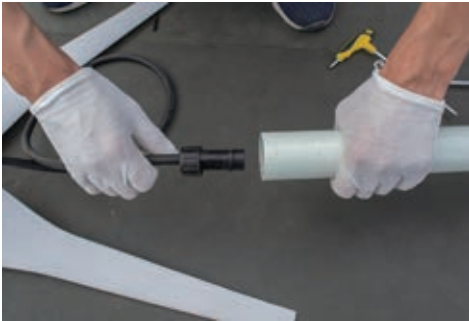
4. 風力発電用のケーブルを接続ソケットに挿入します。
