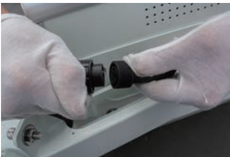
10. ウィンドウプレートを開き、ケーブルとコネクタを接続します。
