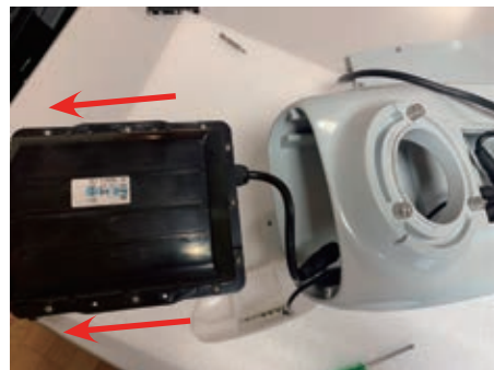
⑤古いバッテリーを取り出します。
