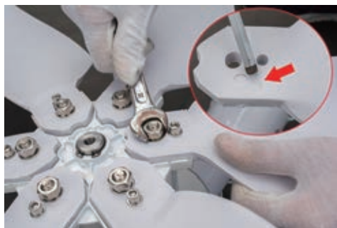
1. 番号が付いたブレードカバーを下向きにして、ネジで平板に固定します。
