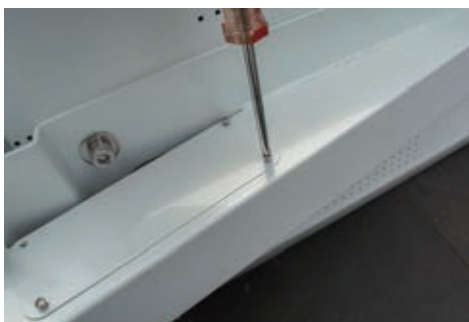
11. 接続部品を入れて、ウィンドウプレートをロックします。
