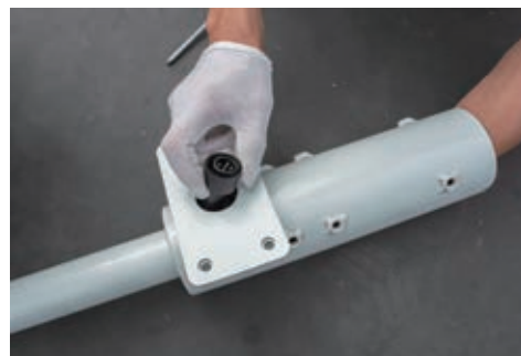
6. 穴から風力発電用のケーブルを取り出します。
